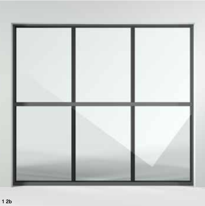
Façade vitrée à six éléments avec montants recouverts de verre, sans cadre apparent: le socle est ici apparent, car le vitrage doit toujours être maintenu par deux côtés.
