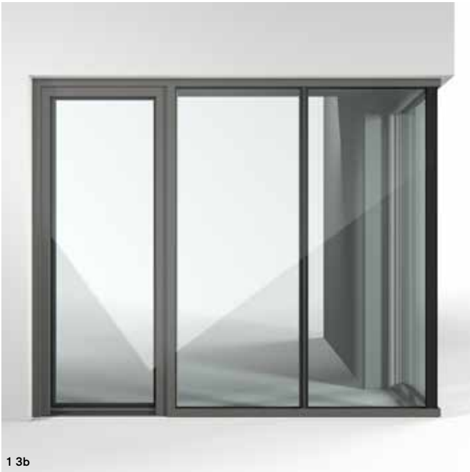
Façade vitrée avec insertion d'une porte-fenêtre sans cadre apparent, trois châssis fixes et angle à l'esthétique tout en verre (partie centrale et angle à 90° recouverts de verre), avec cornière en aluminium à l'intérieur
