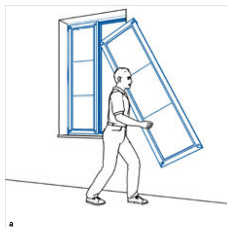
a L'ancien ouvrant est décroché et, si vous le souhaitez, mis au rebut par l'installateur conformément aux prescriptions en vigueur.
