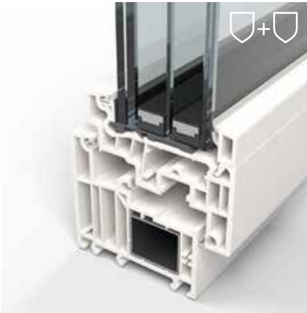
Vue en coupe d'une fenêtre avec triple vitrage isolant, verres extérieurs et intérieurs en exécution Multiprotect, configuration 44.2Sm-13-4F-13-66.2Sm
